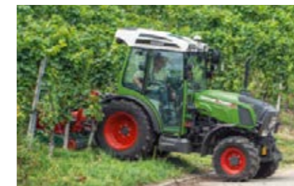
De aftakassen werken onafhankelijk van de rijsnelheid. Met de klepelmaaier rijdt u bijvoorbeeld bij een dicht gewas langzaam en bij een meer open gewas sneller – traploos, zonder schakelen en zonder onderbreking van de krachtstroom.
