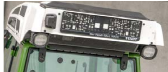
□ Met de led-werklampen achter aan het dak houdt u steeds zicht op de aangekoppelde werktuigen.
