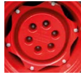
□ Met extra wielgewichten vergroot u de tractie van de achteras.
