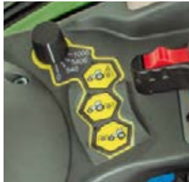
De aftakasschakeling met automatische functie bevindt zich goed toegankelijk op de armleuning.
