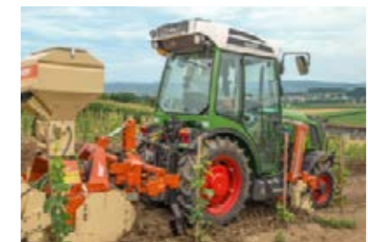
Middenaanbouw – voor economische toepassing van vele werktuigcombinaties.
