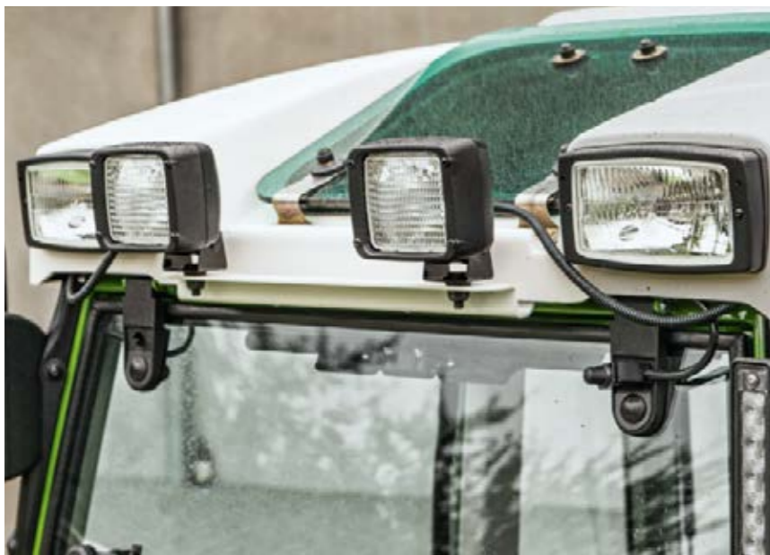
□ Bij de uitvoering met extra schijnwerpers kunnen vooraan twee extra werklampen worden geplaatst.
