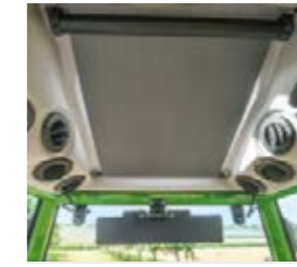
■ Het rolscherm van het dakraam beschermt tegen verblinding door de zon.
