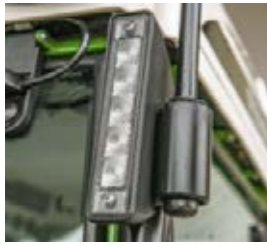
□ Knipper- en -positielichten zijn netjes in de A-stijl weggewerkt.
