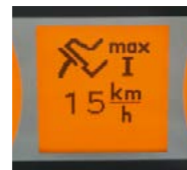
■ Met het aangepaste rijpedaalbereik werkt u nauwkeuriger.
