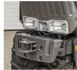
□ Zonder frontheinrichting bevestigt u extra gewicht direct aan het frame.
