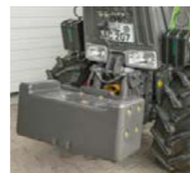
□ Het frontgewicht zorgt voor een betere krachtoverbrenging van de vooras.
