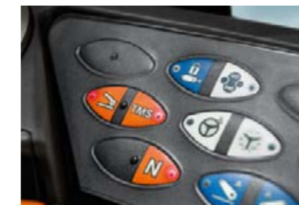
Alle functies zijn eenvoudig en overzichtelijk volgens de beproefde Fendt-bedieningslogica op het folietoetsenbord (met achtergrondverlichting) ondergebracht.
