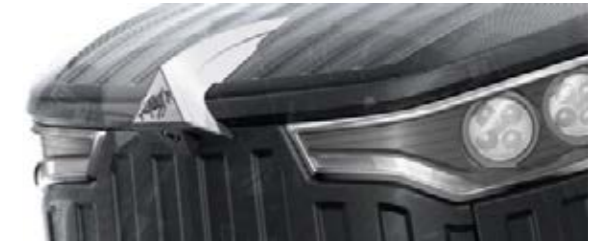
Led-dagrijlicht en werkklampen geïntegreerd in de voorzijde van de motorkap. Motorkapcamera aanwezig.
