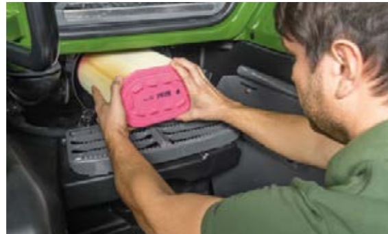
Het cabinefilter bevindt zich op een goed bereikbare plaats bij de instap en kan indien nodig worden gereinigd.
