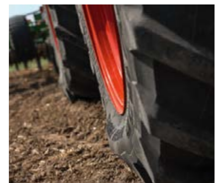
Het perfect geïntegreerde VarioGrip-bandendrukregelsysteem regelt binnen enkele minuten de bandenspanning tussen 0,6 en 2,5 bar. De optimale bandenspanning leidt tot brandstofbesparing, het ontzien van de bodem en betere tractie.
