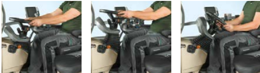
De cockpit zwenkt gelijk met het stuurwiel, voor nog meer bedieningscomfort. Het stuurwiel is eenvoudig verstelbaar via een apart voetpedaal, waarbij de handen vrijblijven voor het verstellen.
