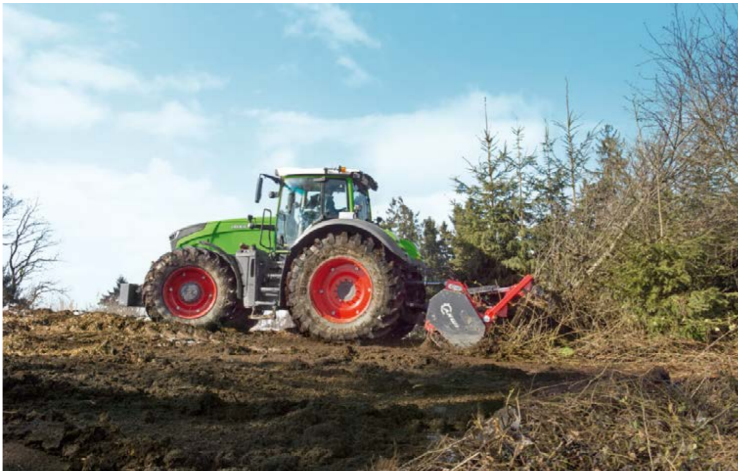
Bij toepassing van de achteruitrijrichting kunnen alle bedieningselementen even comfortabel worden bediend als wanneer gewoon vooruit wordt gereden. Het bestuurdersplatform wordt eenvoudig 180° gedraaid – waarbij alle elementen in de cabine op hun plaats blijven. Ook de bijrijder kan bij gebruik van de achteruitrijrichting gewoon gebruikmaken van de comfortstoel.
