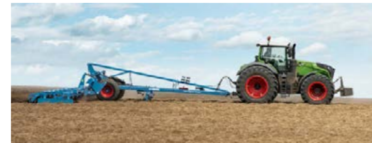
Met behulp van het Trekker Management Systeem (TMS) en de automatische grenslastregeling 2.0 past de trekker het motortoerental automatisch aan de rijnsnelheid aan.
