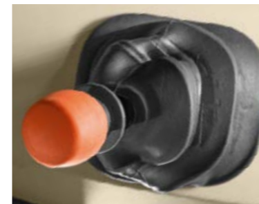
Handremassistent in stand automatisch: de handrem wordt automatisch geactiveerd.
