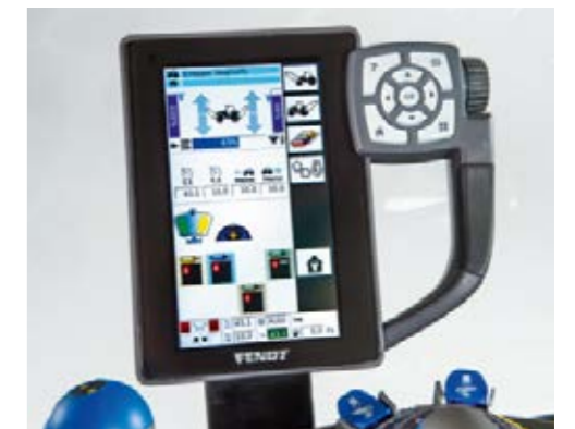
De Varioterminal geeft informatie over de geplande onderhouds- en servicebeurten. Er is zelfs een memofunctie.
