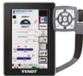
Indicatoren voor kruishendel en weegstelsel: afzonderlijk gewicht, totaalgewicht en begrenzing voor de uitslag van laadarm en werktuig.
